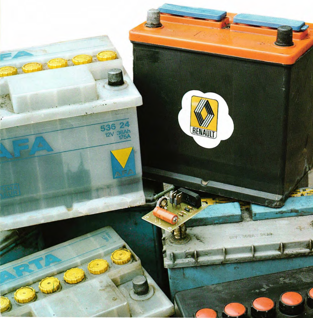
Fig. 1. De thyristor acculader heeft een elektronische schakelaar die wordt bewaakt via een extra circuit om overlading van de accu te voorkomen.
